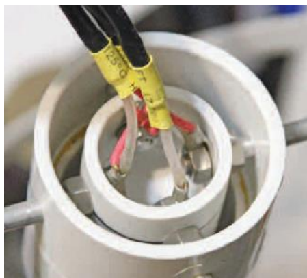
Rys. 5.6.2. Sposób zasilania kablem RG-58. Pętla 1 – zaciski 0° i 180°, pętla 2 – zaciski 90° i 270°. Długość linii fazującej 33 cm, dławik 3 – 5 zwojów Fot. 5.6.3. Wykonanie przyłącza
