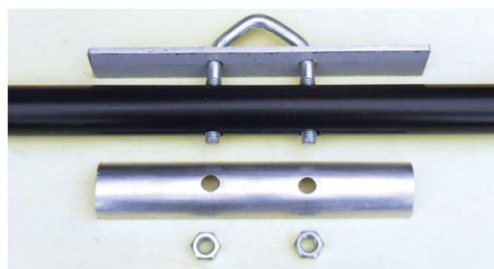
Fot. 3.12.3. Konstrukcja teleskopowego zakończenia wspornika
