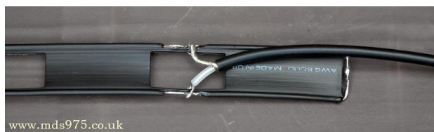
Rys. 4.8.4. Szczegóły konstrukcyjne anteny wykonanej z kabla 450 \Omega przez M0MTJ. Miejsce podłączenia kabla dobrze jest owinać taśmą izolacyjną
