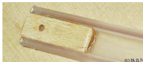
Rys. 4.8.4. Szczegóły konstrukcyjne anteny wykonanej z kabla 450 \Omega przez M0MTJ. Miejsce podłączenia kabla dobrze jest owinać taśmą izolacyjną
