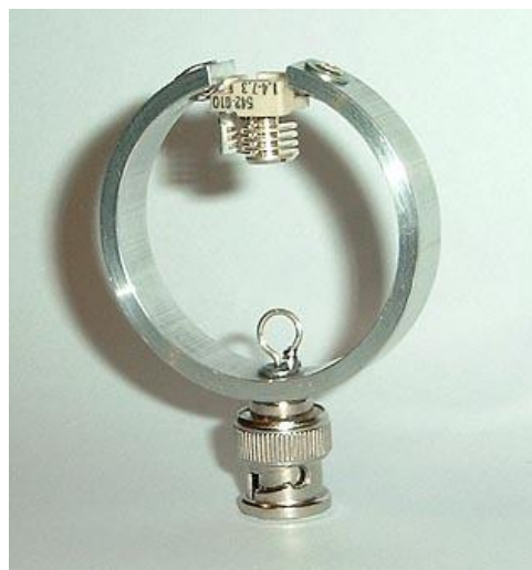
Fot. 6.2 – 6.3. Przykłady wykonania anten magnetycznych na pasma 2 m i 70 cm do radiostacji ręcznych
