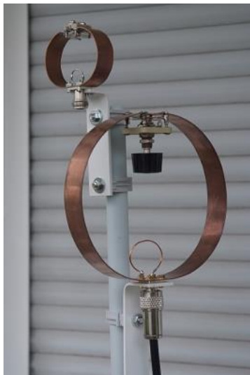
Fot. 6.4. Przykład wykonania anten na pasma 2 m i 70 cm z taśmy metalowej
