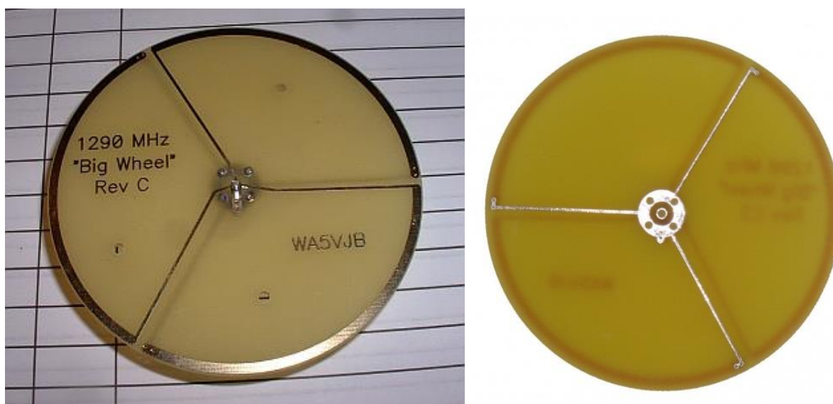
Fot. 5.3.4-5.3.5. Drukowana antena na pasmo 23 cm ma średnicę 72 mm, impedancję wejściową 50 \Omega i zysk kierunkowy 2 dBi
